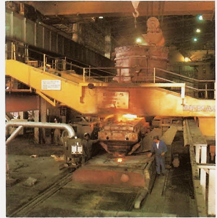
Pfannentransportwagen in Portalausführung für eine Stranggießanlage
