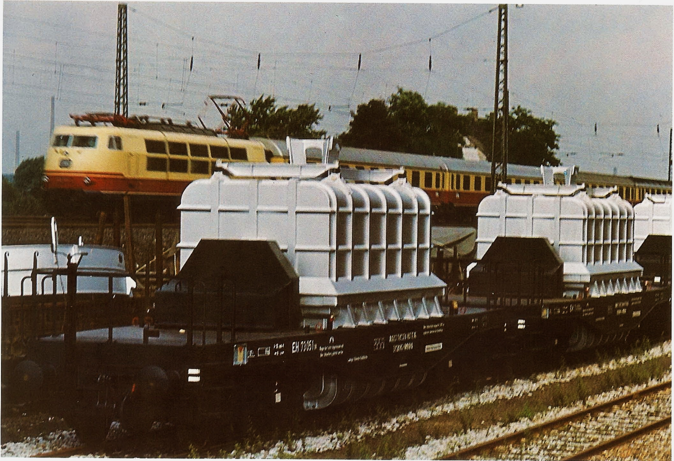
Warmblocktransportwagen für stehende Blöcke. Nutzlast ca. 60 t. Zugelassen für öffentliche Verkehrsnetze
