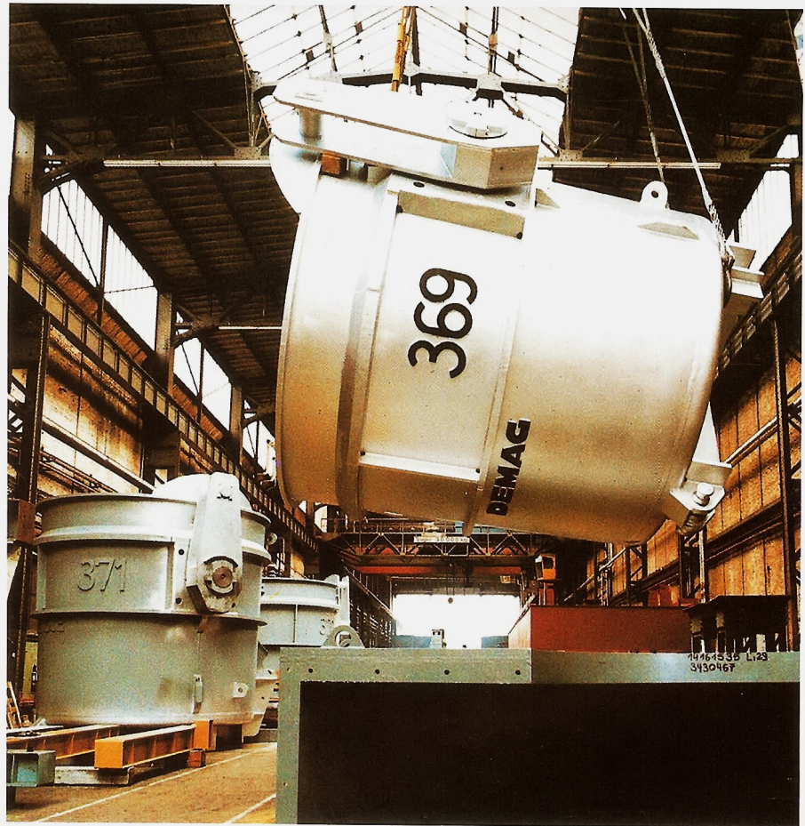
Fertigung im Demag Werk Düsseldorf-Benrath von 14 Stahlgießpfannen mit 140 t Fassungsvermögen
