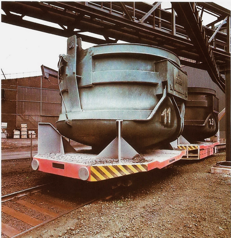
Bild unten: Schrottkorbtransportwagen ausgerüstet mit elektrischem Fahrtrieb. Tragkraft 110 t
