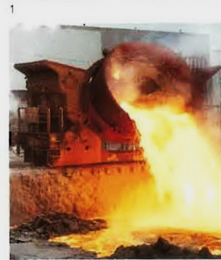
1 Pfannenkipstuhl in einem Entschwefelungsstand mit automatischer Argonzufuhr
