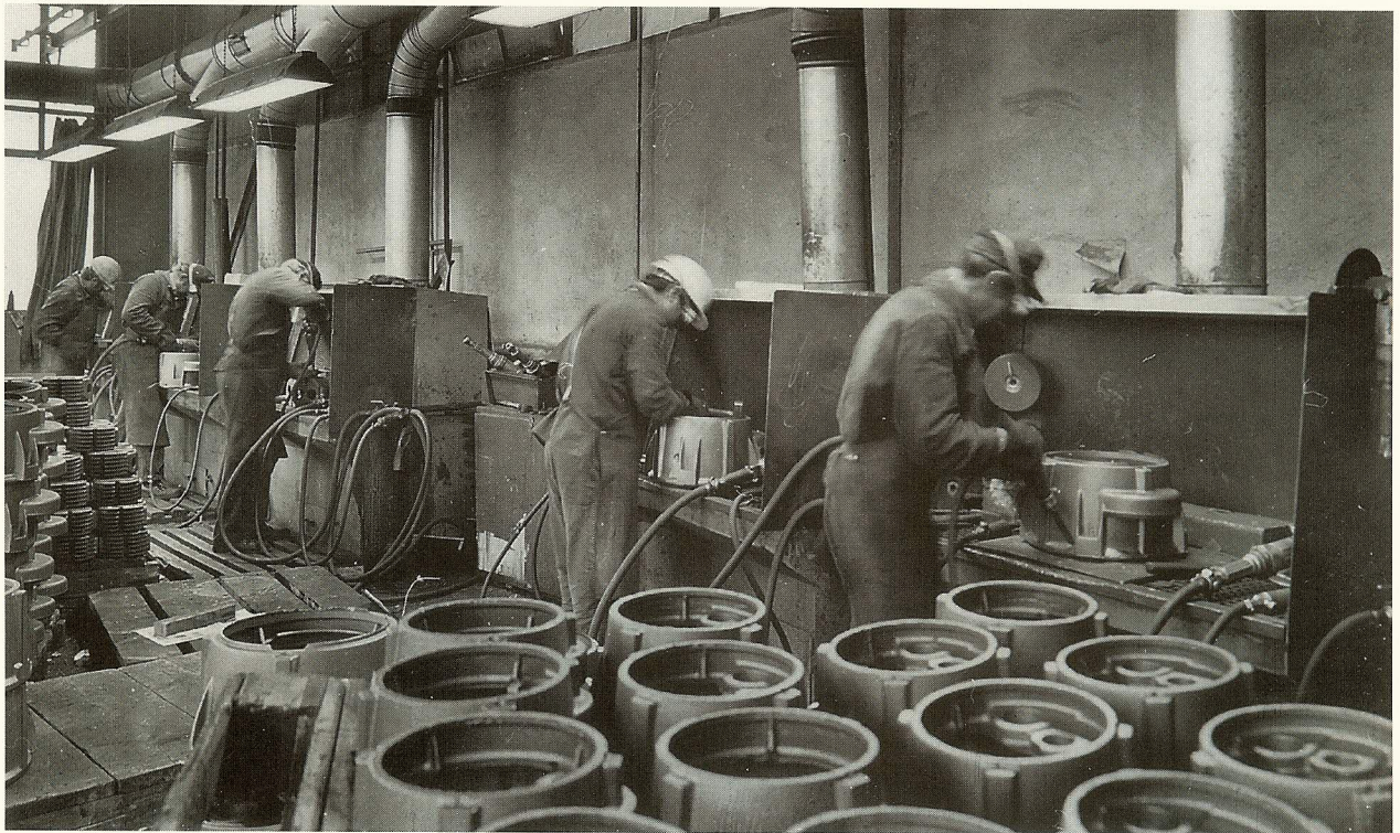
Die gleiche Arbeit, die früher in der „Schleif“ verrichtet wurde, erledigen heute die Arbeiter durch Sandstrahlen bzw. mit elektrisch getriebenen Maschinen in der Putzerei für Maschinen-Formguß. Hier werden die Gußstücke von Grat und Formsand befreit.
