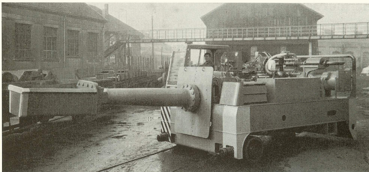
Chargierwagen zum Befüllen von Schmelzöfen. Im Hintergrund erkennt man die Fußgängerhochbrücke. Sie war Fortsetzung der Bahnunterführung und verband die Bahnhofstraße mit der Feusdorfer Straße.
